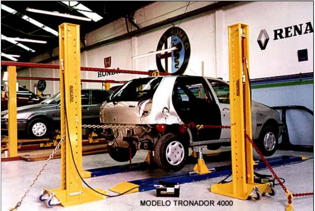
Las BANCADAS **TRONADOR 4000** - Permite la fijación de cualquier tipo de vehículos de carrocerías autoportantes, utilitarios con y sin chasis (con chasis OPCIONAL: caballetes y accesorios de anclaje y amarre), es de destacar que una carrocería del tipo autoportante se podrá fijar sobre la bancada, desde un tiempo de 15 minutos y hasta un máximo de 20 minutos, de acuerdo al tipo de carrocería o daño sufrido en la misma.-
